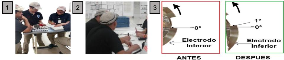
Después de la reubicación del pin de referencia del electrodo inferior obtuvimos una reducción del 38.46% en el porcentaje del defecto de «Ángulo de fan fuera de especificación» que va del 0.013% al 0.008% lo que representa 7 piezas reducidas. También describimos los aspectos positivos y negativos de la implementación de esta reubicación de pin de referencia.
