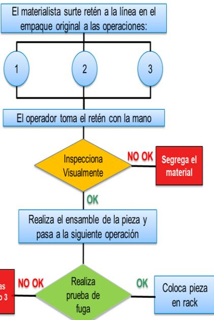
Después de analizar el proceso actual identificamos que no se está respetando la especificación de Ingeniería, la cual menciona **que el componente debe instalarse con las herramientas apropiadas sin desgarrar ni alterar el pre-lubricante (grasa interna), ni distorsionar la caja metálica y resorte.**
